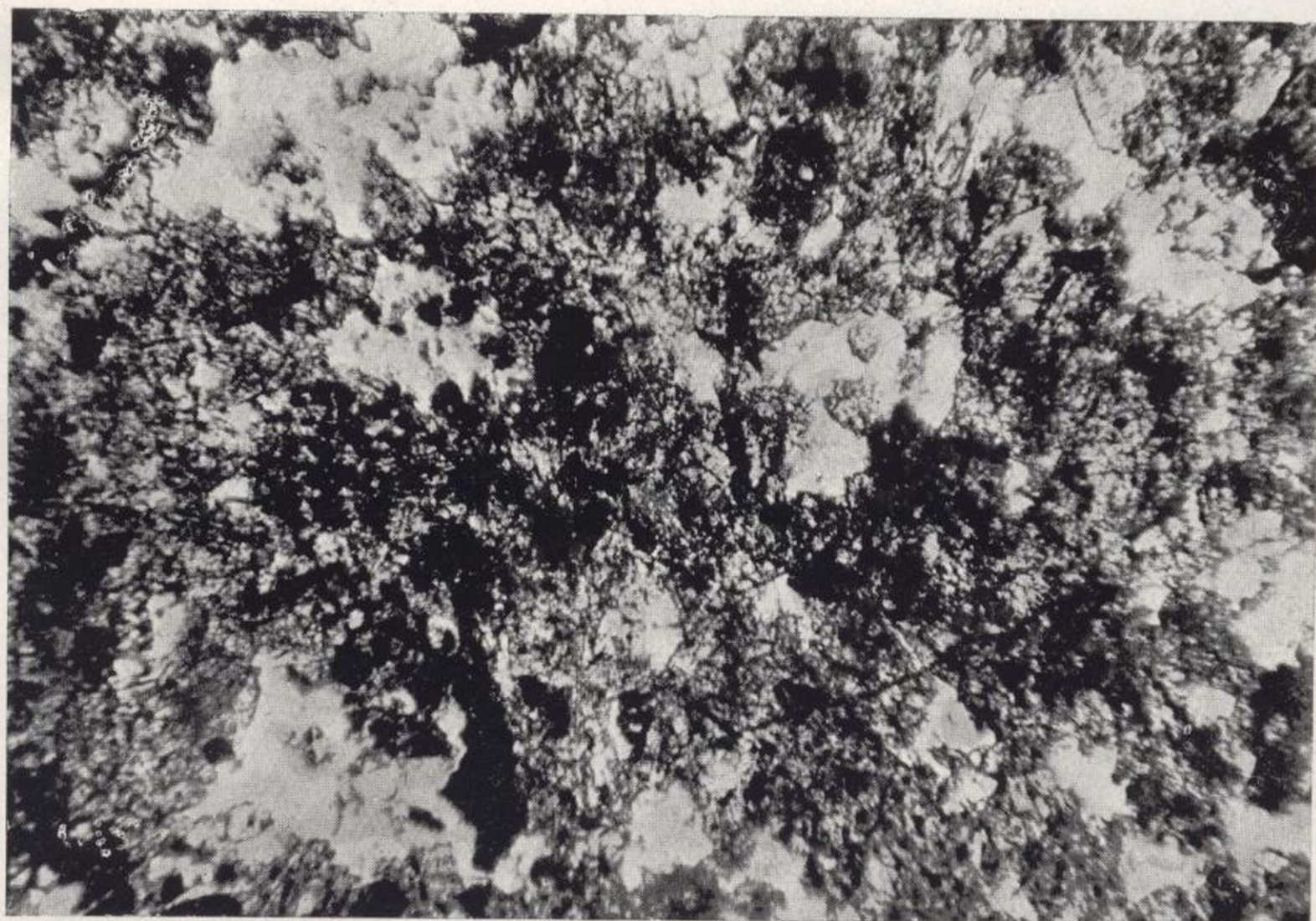
Fot. 20.—Cuarzo granular y epidota en una epidosita. Muestra n.º 28. \times 30 . N. ||.
